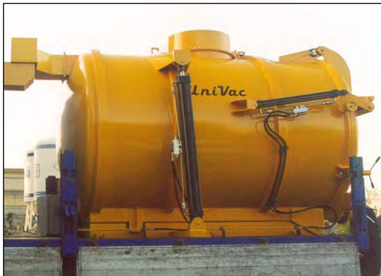
Citernes à cyclone avec basculement et ouverture hydraulique du portillon de décharge.
